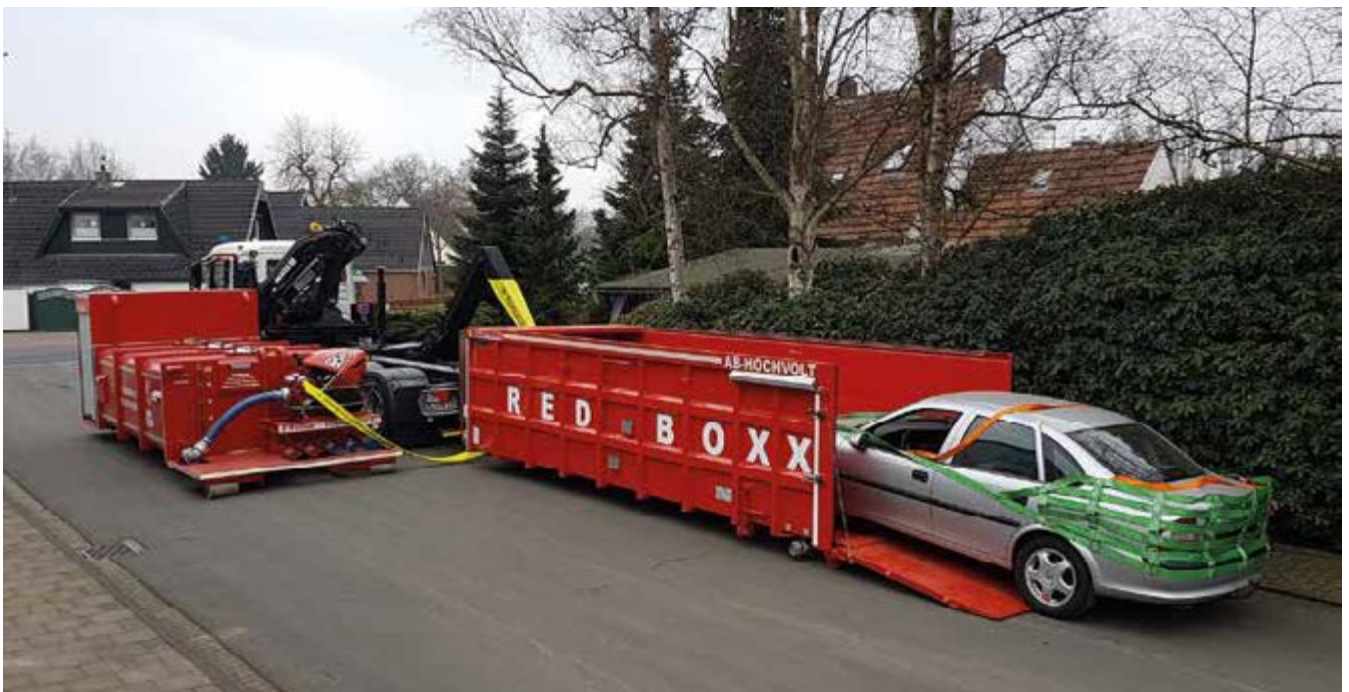
Az Ellerman Eurocon GmbH RED BOXX sérült nagyfeszültségű villanyautó legördíthető konténerfelépítménye.
