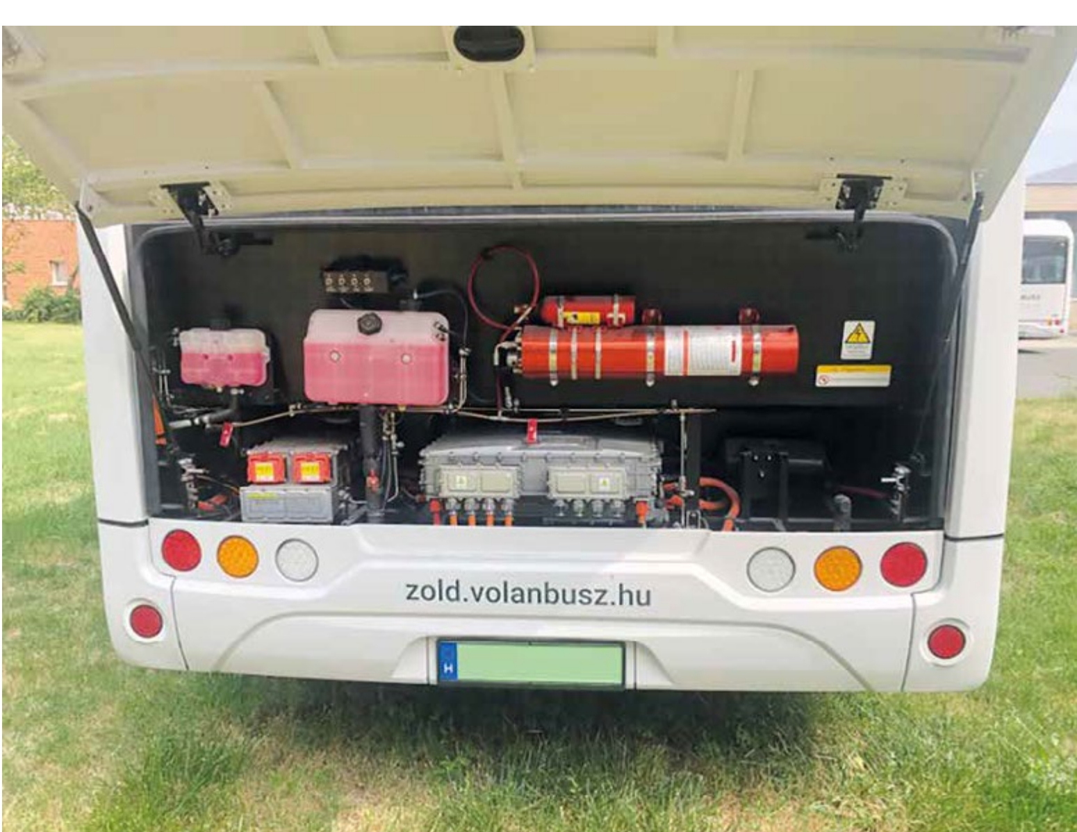
A Volánbusz tisztán elektromos járműve beépített oltóberendezésének tartaléka a motortér jobb felső részén
