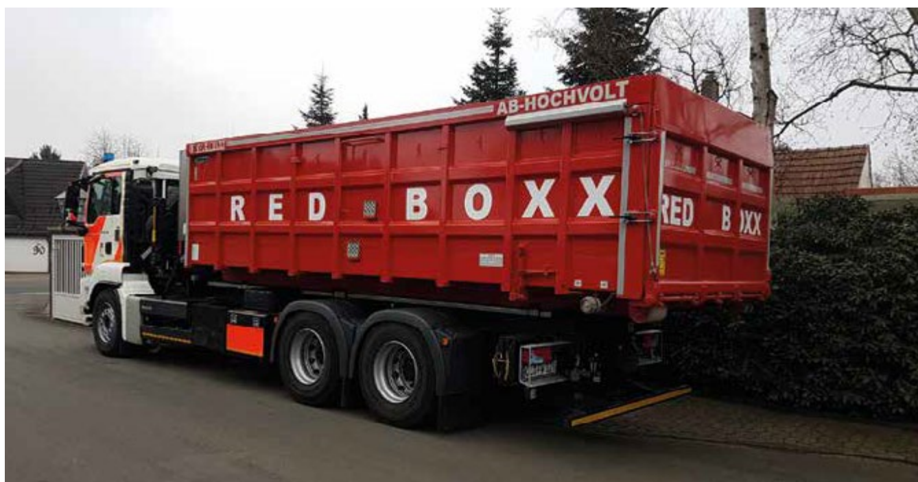
Az Ellerman Eurocon GmbH karambolos villanyautó elszállító konténere, mely a villanyautó sérülésétől függően vízzel elárasztható, illetve az autó vízszugárral permetezhető.
