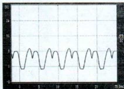
5. b ábra: egy szakadt fázistekercs oszcillogramja a B+ és a csillagponti kivezetések között
