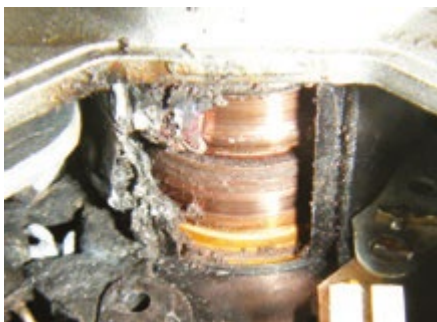
Erős kopás a csúszógyűrűnél és a szénkeféknél
