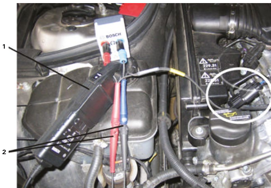
2. ábra: 1 – árammérő fogó a pozitív oldali vezetékre helyezve, 2 – a feszültségmérés mérővezetékei
