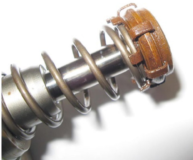
1.27. ábra: Vizes gázolaj, korrózió
