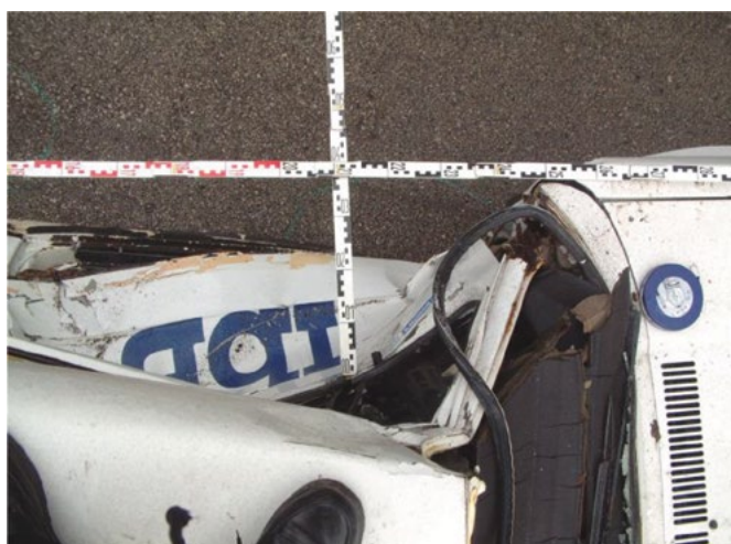
33. ábra A VW Golf személygépkocsi crash-adatai
