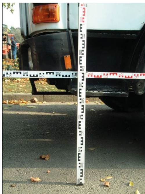
36-37. ábra A személygépkocsi deformációs tartománya és nagysága
