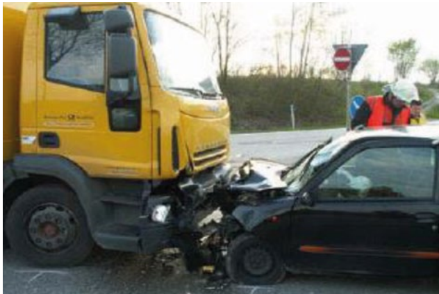
8. ábra Tehergépkocsi front aláfutásgátló 2006/40/EC előírás szerint
