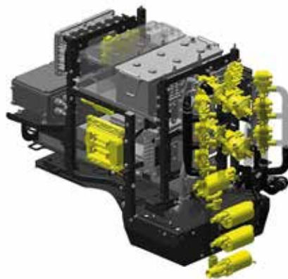
13 Termomenedzsment szerkezet-blokk (Cooling Box) az MPB-re szerelten
