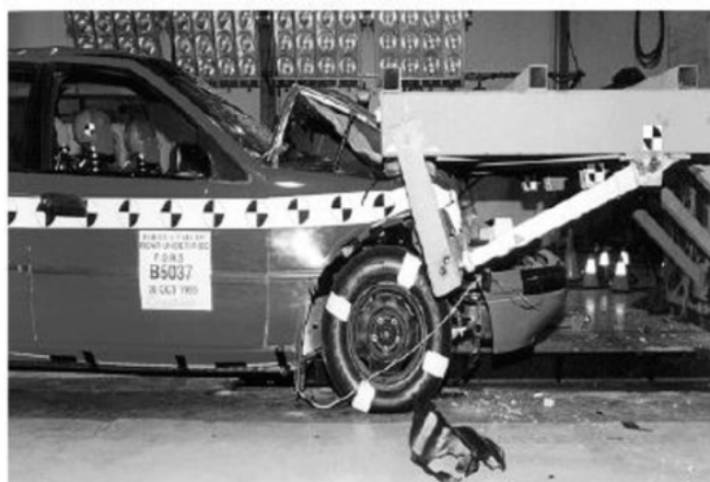
67-68. ábra Az energia felvevő hátsó aláfutásgátló működése és kísérleti ütközés 48 km/h-val. (m = 1830 kg)
