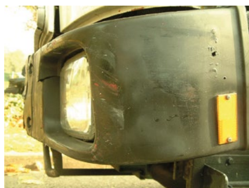
38-39. ábra A tehergépkocsi első részének kismértékű deformációi ( s = 5 - 5,5 \text{ cm} )
