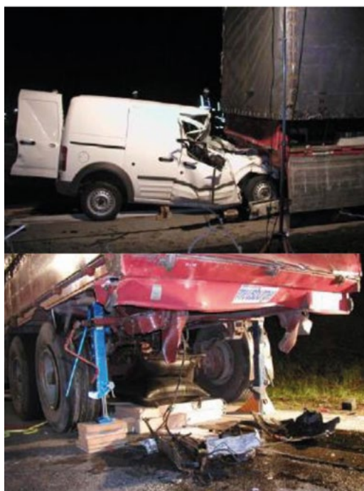
62. ábra Hátsó aláfutásgátló szignifikáns negatív eredménnyel
