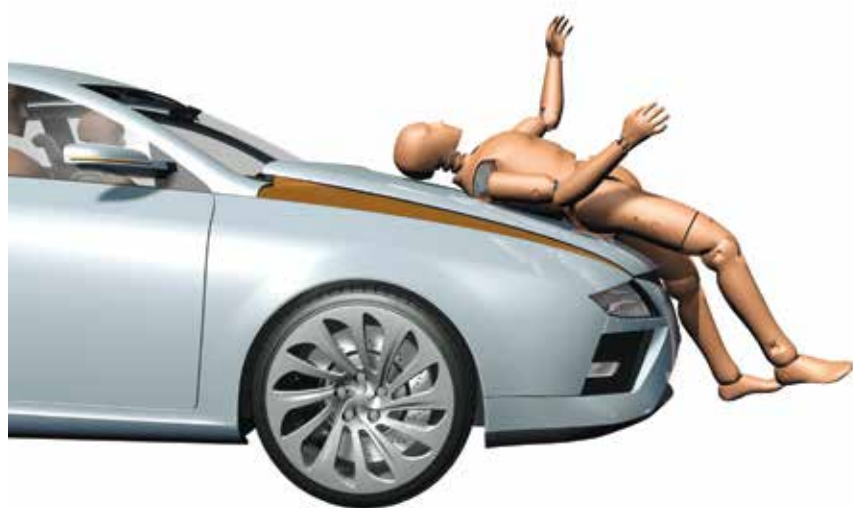
A gyalogosgázolás vizsgálata dummy-val
