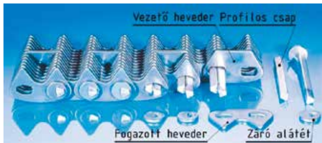
❸ A láncajtás hátrányait enyhíti a fogaslánc, amivel nagyobb sebesség érhető el, ráadásul a járása is halkabb, mint a hagyományos (csapos) láncoké.
