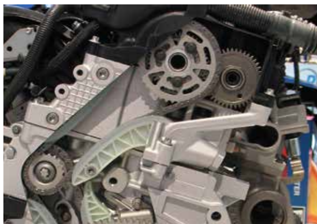
9 Előszeretettel alkalmaznak fogaskerék-hajtást az egyik vezérműtengelyről másira történő áthajtásra.
