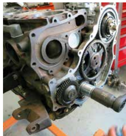
8 A Toyota 1HD-T kódú motorja fogaskerék-vezérlésű.
