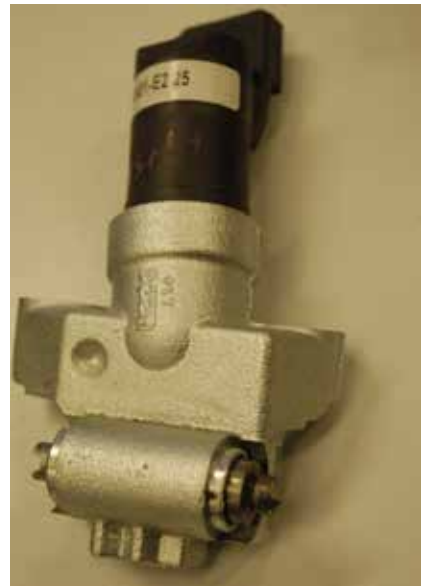
Duo-servo dobféket működtető elektromechanikus rögzítőfék Electrical Parking Brake - Duo Servo, (EPB-DS)
