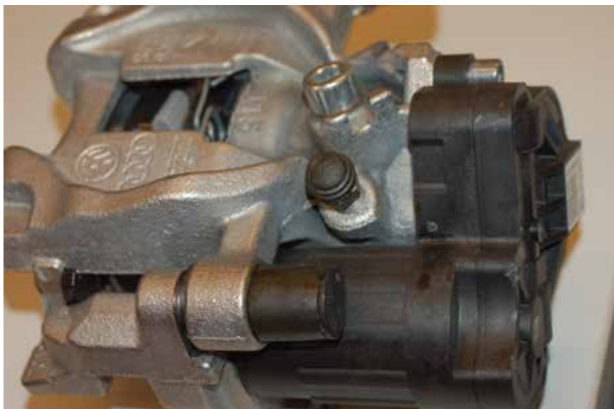
Continental Teves EPB-Ci, féknyeregbe integrált elektromechanikus rögzítőfék.
