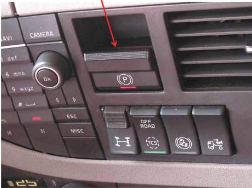
A műszerfalon elhelyezett rögzítő fék kapcsoló (Volvo)
