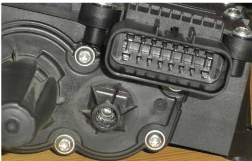
16 pólusú elektromos csatlakozó és a szükség fékoldás lehetősége.
