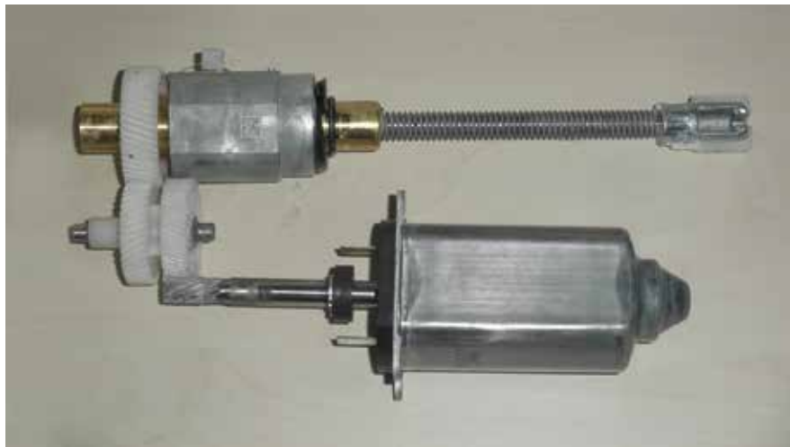
Az Opel bowdenes működtetésű EPB belső áttétele.
