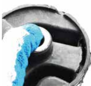
10 Nem megfelelő szerelési irány eredménye.
