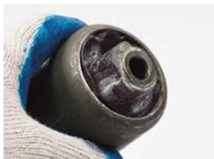
11 Helytelen pozícióba szerelt szilent.
