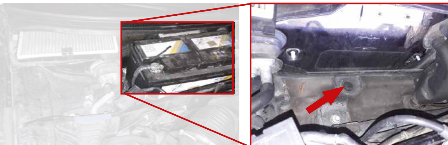
Vízlefolyó az akkumulátor alatt.
