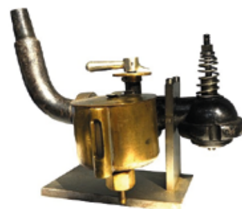
8 Bánki–Csonka-féle karburátor szabadalmi rajza és maga a kész szerkezet
