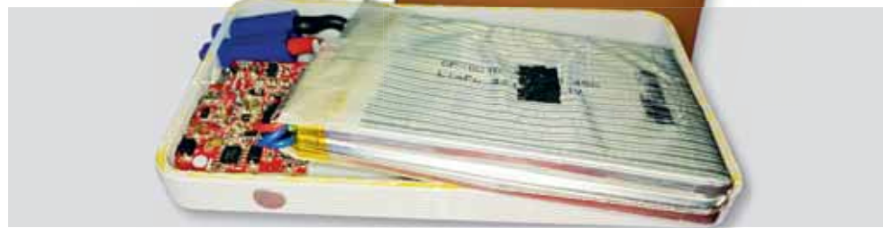
2 3 CP-02 indító akkumulátor és felépítése
