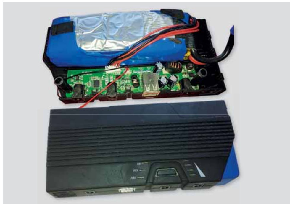
4 5 CP-05 indító akkumulátor és felépítése
