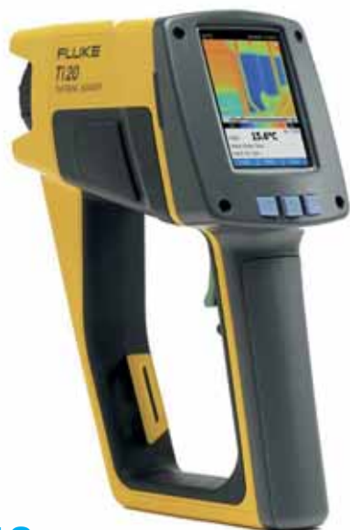
7 Fluke Ti-20 hőkamera a melegedés ellenőrzéséhez
