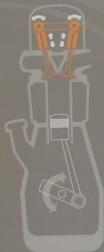
VENTILSTEUERUNG ÜBER ZWEI OBEN LIEGENDE NOCKENWELLEN
