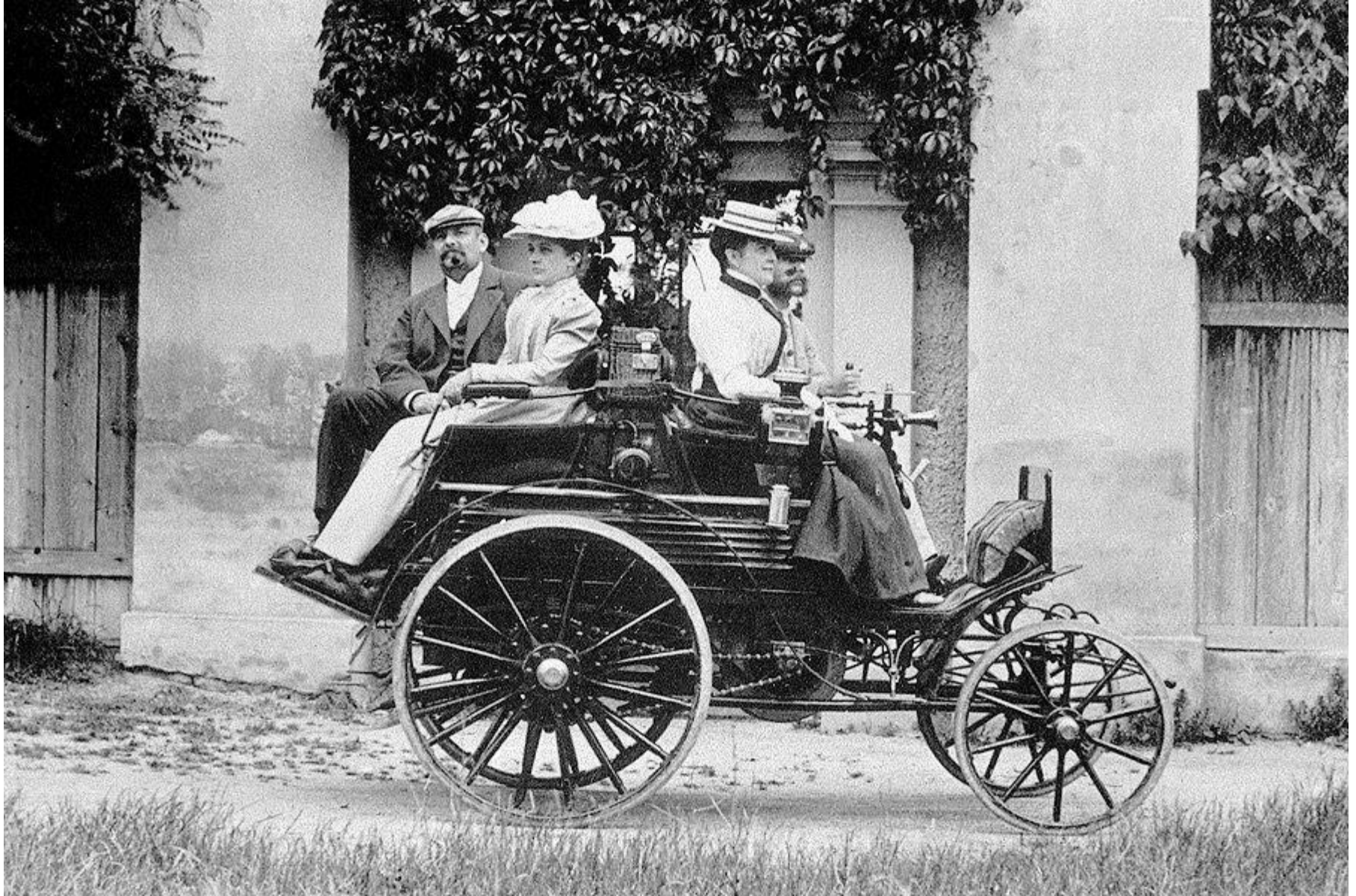
Dos-à-Dos - Rücken an Rücken -, so heißt das Benz-Automobil, das von 1899 bis 1901 gebaut wurde. Als Antrieb dienten Zweizylinder-Boxermotoren.
