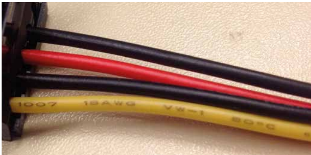
❸ 18 AWG-s vezeték méret-jelölés a szigetelésen
