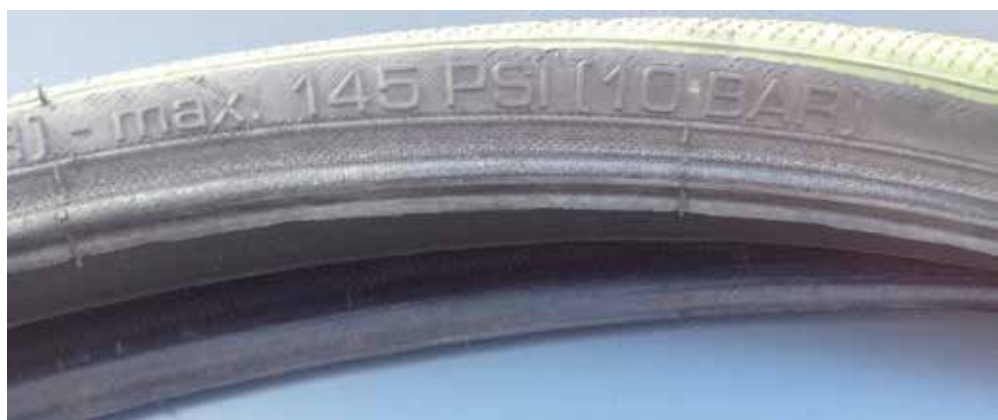
❶ Kerékpárkülsőn is látható, hogy 145 PSI 10 bar nyomásnak felel meg
