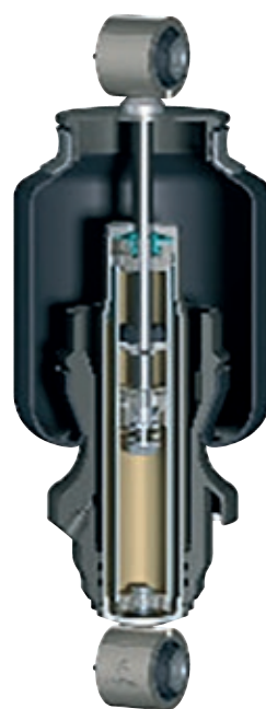
SACHS Air Spring Module (légrugós modul) család tagja, amelyet buszokban, kamionokban és nehéz haszongépjárművekben alkalmaznak
