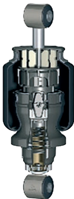
CALM® vezetőfülke-rugózási modul teherjárművekhez, integrált légrugóslengéscsillapító
