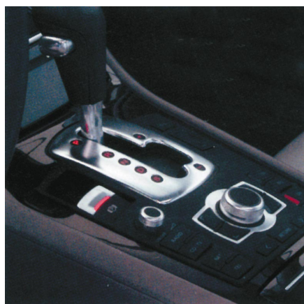
2. ábra: az A8-as EPB-kapcsolója balra a Tiptronic-kulissza mellett
