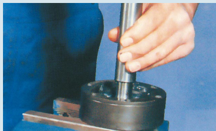
4. A csukló és a tengely szétválasztása.
