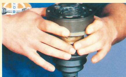
4. Az agyba beszereljük a tengelyt és ütközésig belenyomjuk.
