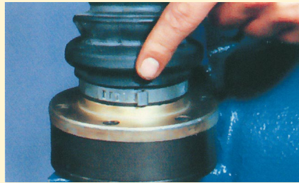
7. A belső bilincs rögzítőszemének elhelyezésénél ügyeljünk arra, hogy az két furat között legyen.
