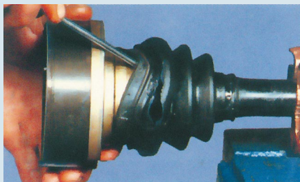
3. A gumiharang bilincseinek leszerelése, majd a porvédő lehúzása a belső tárcsáról, ügyelve, hogy ne sérüljön meg.
