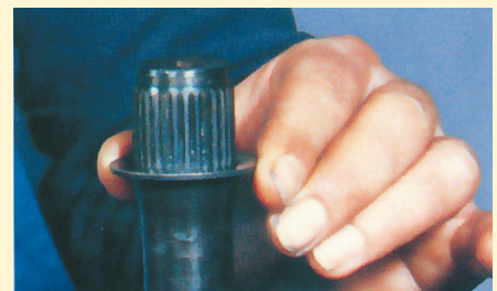
2. Felhelyezzük a tányérrugót a megfelelő helyzetbe (ha a típus megkívánja).
