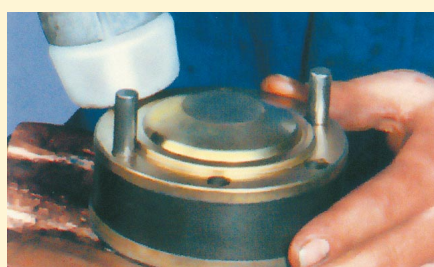
10. Műanyag kalapáccsal a védőlemez rákocogtatása. Figyeljünk a furathelyekre!
