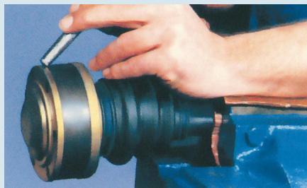
1. A porvédő zárólemez eltávolítása, ügyelve arra, hogy ne sérüljön meg.
