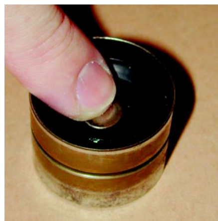
1. ábra: ha a kiszerelt hidraulikus emelő kézzel gyorsan összenyomható, cserélni kell
