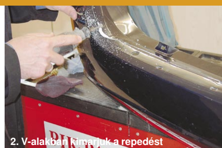
2. V-alakban kifarjuk a repedést
