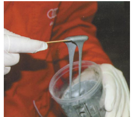
6. ábra: Az összekevert nyúlós tömítő masszát a sérült helyre kenőszerszámmal kell felvinni
