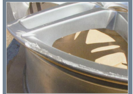
1. ábra: Lakk buborékok a keréktárcsán, miután a keletkezett karcokat nem szüntették meg
