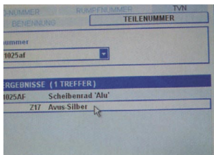
3. ábra: Segítség az Audi keréktárcsa hátlapján található szinkód lehívására az alkatrészszám segítségével
