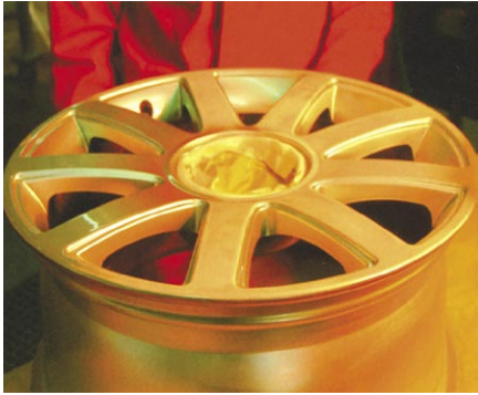
9. ábra: A szárítás (ideje csökkenthető infravörös sugárzó használatával)
