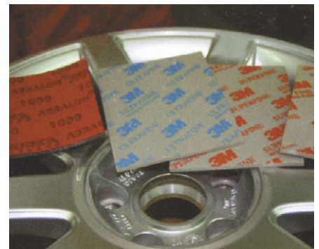
8. ábra: A finomcsiszolás megfelelő papírral (1000)
