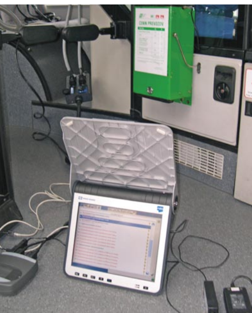
Használat közben egy háromtengelyes MAN városi autóbusznál, a Main adapter és a Switch box az első utasülésen, a CMU a laptop mellett
