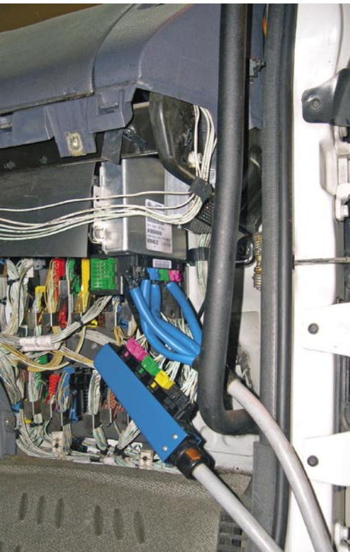
A diagnosztikai rendszer csatlakoztatása az elektromos rendszerhez Renault nyergesvontatónál
