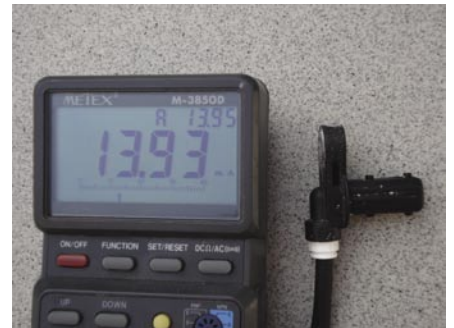
2. ábra: a szenzor nagy értékű áramfelvétele
