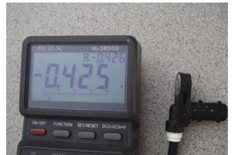
4. ábra: a szenzor áramfelvétele fordított polaritású bekötés esetén
