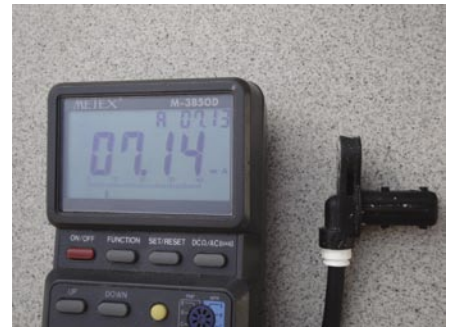
3. ábra: a szenzor kis értékű áramfelvétele
