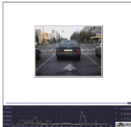
Beállításától függően egy határozott fékezés (0,8 G) is aktiválhatja a Video Boxot
