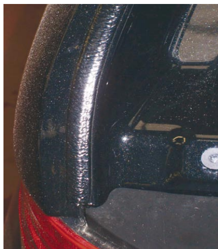
3. kép: csomagtartóél-tömítés Terostat 9120 termékkel (Mercedes B osztály)
