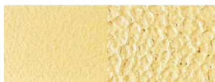
5. kép: Terostat 9320 szórható tömítő felviteli módjai
