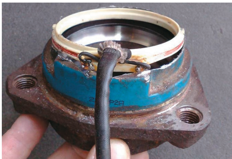
3. ábra: a mágneses gyűrű a jeladótekercssel, a csapágyházból kiemelve
