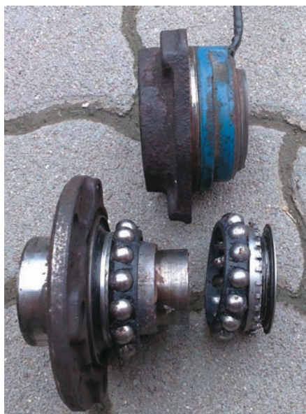
2. ábra: a kerékcsapágyak és a lemez póluskerék a házból kihúzva
