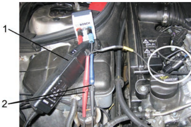
2. ábra: 1 - árammérő fogó a pozitív oldali vezetékre helyezve, 2 - a feszültségmérés mérővezetékei
