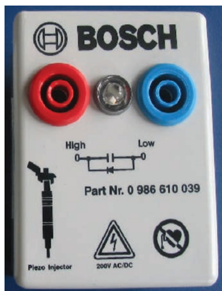
1. ábra: piros banánhüvelyaljzat „High Side”, pozitív; kék aljzat „Low Side”, mínusz
