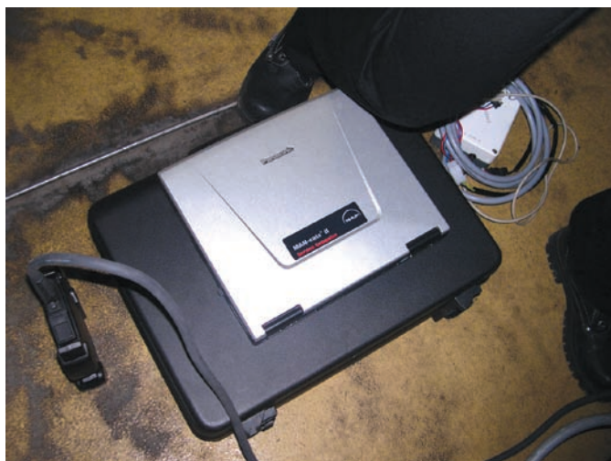
Az MAN-nél rendszeresített diagnosztikai műszer az MANcats, már a II. generáció van használatban
