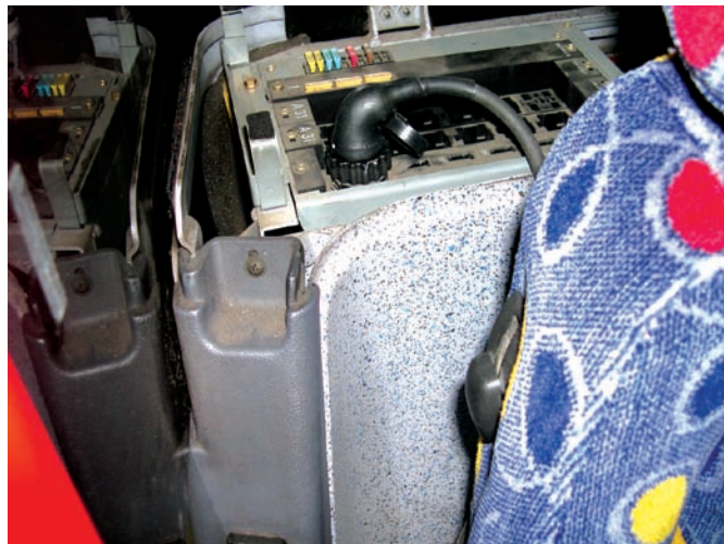
A Mercedes Citaro diagnosztikai csatlakozója a vezetőülés támlája mögött
