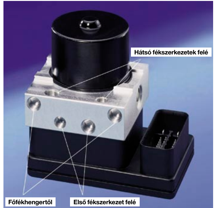
1. ábra: MK70 ABS-egység
