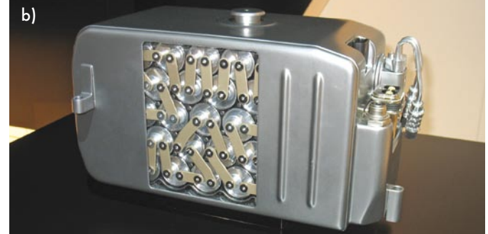
4. a, b ábra: 1 hűtőmodul, 2 Li-ion cella, 3 akkumulátormenedzsment rendszer, 4 hűtőközeg-csatlakozás, 5 nagyfeszültség-csatlakozás, 6 cellafeszültség-felügyelet
