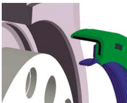
Az 1. PTFE tömítésgeneráció tömítőajkát a tengelyre szerelés előtt meg kell nyitni és ehhez célszerűen kell használni. A szerelésnél a tömítőajka kifordulásának veszélye fennáll
