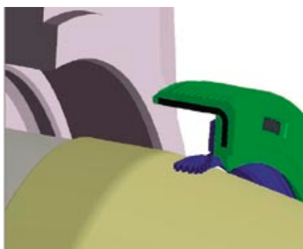
Az 1. PTFE tömítésgeneráció tömítőajkát a tengelyre szerelés előtt meg kell nyitni és ehhez célszerűen kell használni. A szerelésnél a tömítőajka kifordulásának veszélye fennáll
