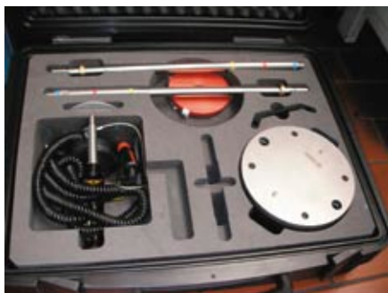
A lézeres tájolóberendezés tartozékai: tájolórudak, lézerpontier, elektromos csatlakozó, tapadókorongos konzol és a hitelesítéshez szükséges korong
