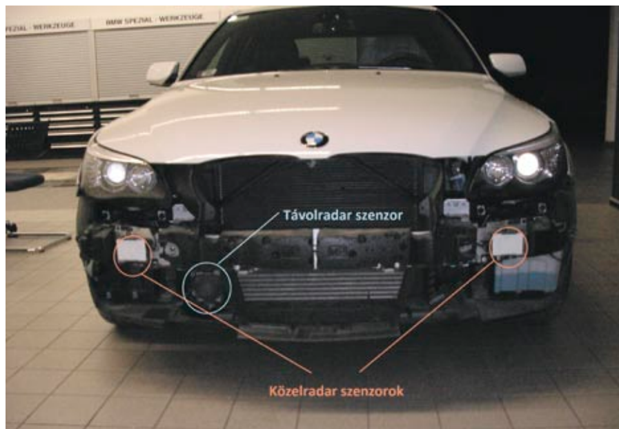
A BMW gépjárműveinél a távolradar- és közelradarszenzorok a lökhárító bal alsó légbeömlőjénél találhatóak, mellette jobb és bal szélén találhatóak a közelradar szenzorai
