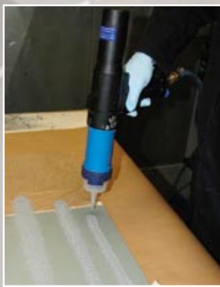
2. generáció: mintegy 15 éve megjelentek a kartus kinyomó pisztolyok. Ezzel már helyreállítható volt az eredeti tömítés. A pisztolynyomás, a távolság és a sebesség változtatásával pedig különböző felületeket lehetett kialakítani.
