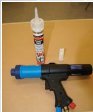
3. generáció: az új fejlesztésű PowerLine II pisztoly és a flatstream-csőr a Henkeltől alkalmasak a legmodernebb tömítési formák kialakítására. Barázdastruktúra vagy sima: az eredeti gyári alkalmazáshoz hasonlóan képes a PowerLine II pisztoly a nyomás, a távolság és a sebesség változtatásával különböző felületeket kialakítani.
