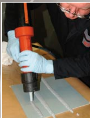
2. generáció: mintegy 15 éve megjelentek a kartus kinyomó pisztolyok. Ezzel már helyreállítható volt az eredeti tömítés. A pisztolynyomás, a távolság és a sebesség változtatásával pedig különböző felületeket lehetett kialakítani.
