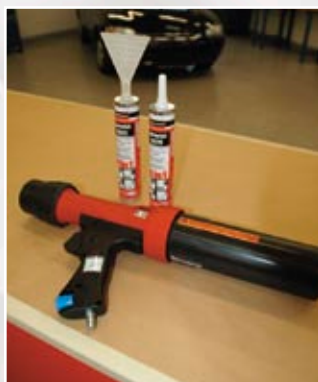
3. generáció: az új fejlesztésű PowerLine II pisztoly és a flatstream-csőr a Henkeltől alkalmasak a legmodernebb tömítési formák kialakítására. Barázdastruktúra vagy sima: az eredeti gyári alkalmazáshoz hasonlóan képes a PowerLine II pisztoly a nyomás, a távolság és a sebesség változtatásával különböző felületeket kialakítani.
