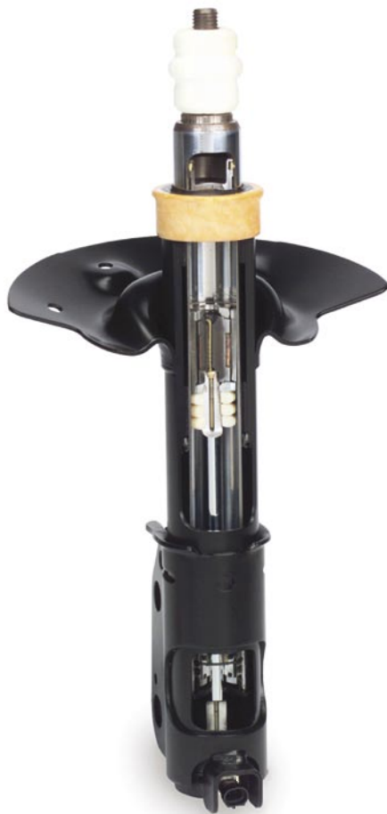
Delphi MagneRide™ lengéscsillapító-metszet
