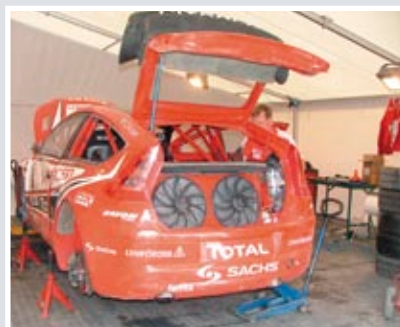
Nem mélynyomó, a sérülések miatt van itt a hűtőrendszer
