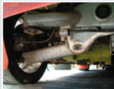
Honda Civic egyedi hátsókerék-hajtású futóműve
