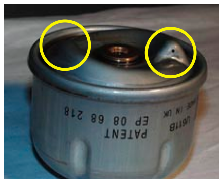
A centrifugál-olajszűrő. A karikával jelölt helyeken találhatóak az olaj kilépőfuratai. Ez a komplett alkatrész cserélendő a szervizperiódus leteltével
