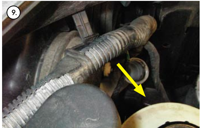
A vezetékkezeletet húzzuk ki a tartóból, majd nyomjuk el oldalra, így könnyebben hozzáférhető a fényszóróház hátoldala! Az izzócseré további lépései megegyeznek a vezetőoldali izzó cseréjének lépéseivel!
