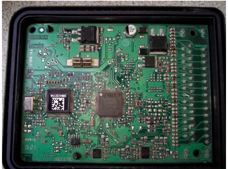
7. ábra: MK60-as ESP-elektronika belső felépítése
