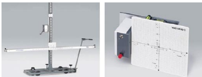
VAS 6430/1 műszerállvány és VAS 6430/2 lézeres egység
