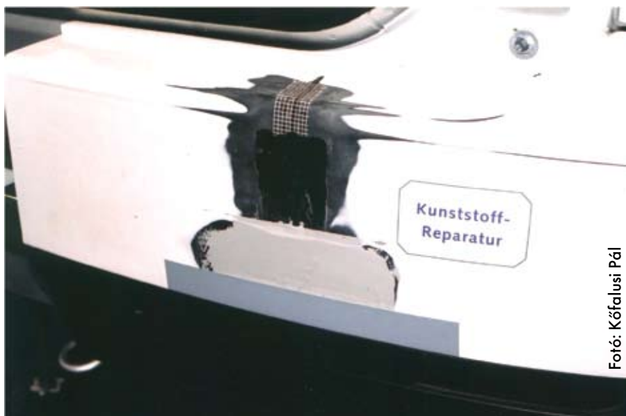
A műanyag elem javítása
