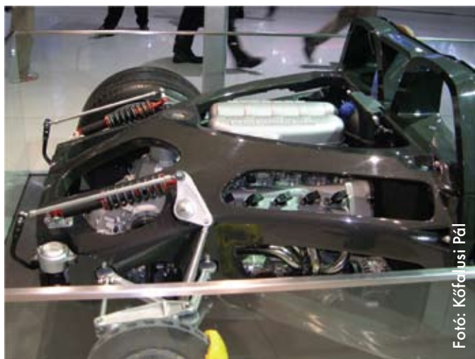
Porsche Carrera GT szénsszál-erősítésű műanyag váz
