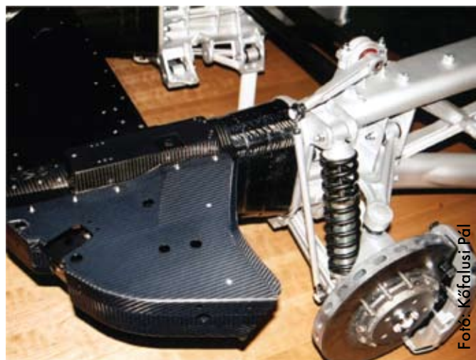
A McLaren Mercedes szénsszál-erősítésű első műanyag elemei
