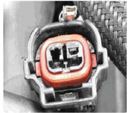
2. ábra: a csatlakozóházba becsúszott érintkező
