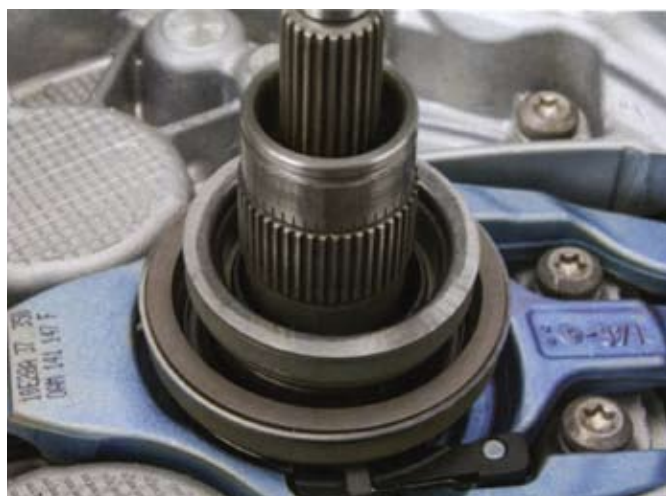
16. ábra: a kis kinyomócsapágyat behelyezni és biztosítani, hogy a fülek a kis kinyomócsapágy hornyaiba beleüljenek
