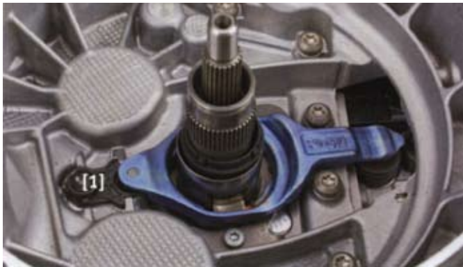
3. ábra: Az új kinyomóvillát a K2 tengelykapcsolóhoz a vezetőhüvellyel és az új tartót beszerelni; a tartó a vezetőhüvely rögzítése felett helyezkedik el. Az új csavarokat 8 Nm+90°-kal meghúzni. A kinyomóvilla helyes pozícióját biztosítani az ellentartónál (1). Figyelem: Alkatrészeket tilos olajozni, vagy zsírozni!
