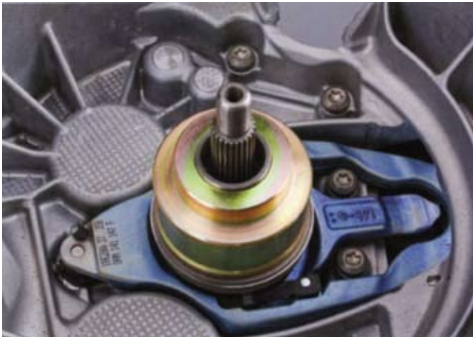
8. ábra: a 48,63 mm-es idomszert (KL-0500-6033) a nagy kinyomócsapágyra ráhelyezni
