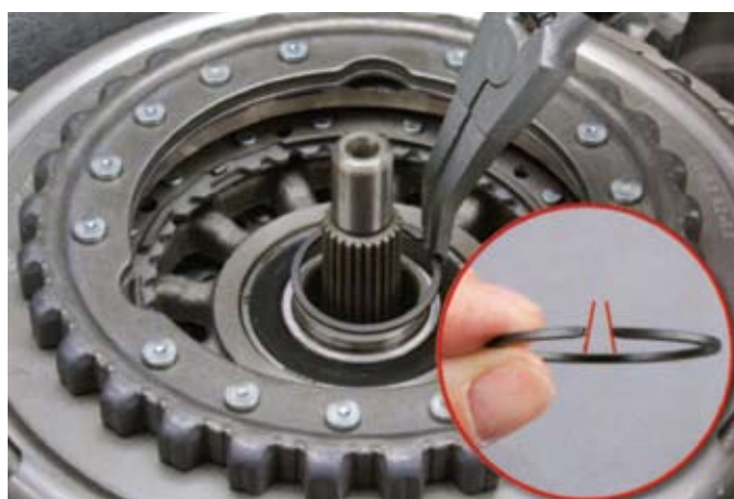
25. ábra: a Seeger-gyűrűt a Seeger-gyűrű-fogóval (KL-0192-12) a csőtengelyre szerelni.
