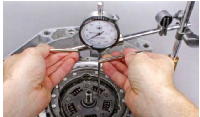
33. ábra: Megjegyzés: a légrésnek (a tengelykapcsoló valós hézaga) minden mérési irányból 0,3 mm és 1,0 mm között kell lennie. Ha a mért értékek kívül esnek ebből a tartományból, akkor a beállítás hibás, meg kell ismételni, lehetséges hogy a hézagolálótét nem lett korrekten pozícionálva.
