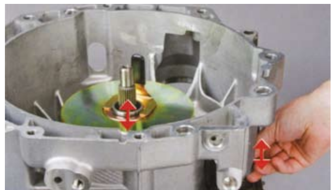
12. ábra: ellenőrizze, hogy a megfelelő hézagolóalátétet szerelte be; a megfelelő kinyomóvillával a kinyomócsapágyat és a ráhelyezett 3,5 kg-os tömeget axiálisan megmozgatni az ellenőrzővilla ellenében.
