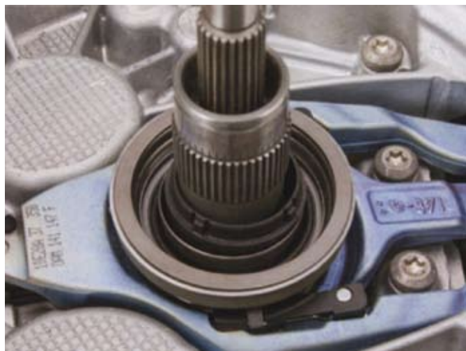
14. ábra: a fentebb leírt módon meghatározott hézagolóalátétet a nagy kinyomócsapágyon (K1 tengelykapcsoló) a számára kialakított helyre kell illeszteni és rögzíteni.
