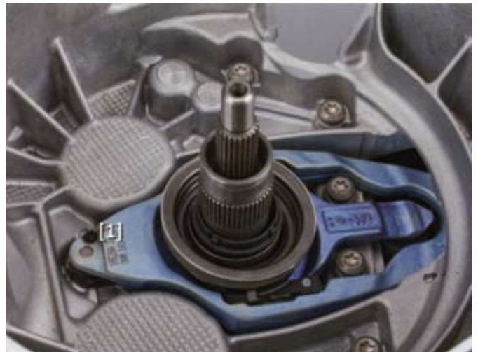
5. ábra: az új kinyomóvillát a K1 tengelykapcsolóhoz és az új kinyomócsapágyat beszerelni. A kinyomóvilla helyes pozícióját biztosítani az ellentartónál (1)
