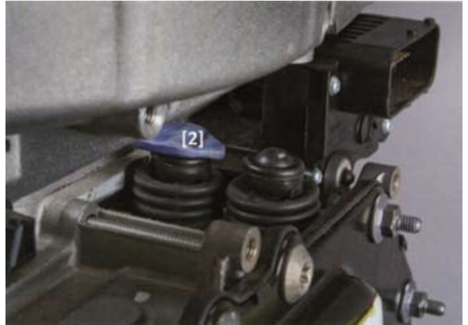
4. ábra: a kinyomóvilla helyes pozícióját biztosítani az állítóhengernél (2)
