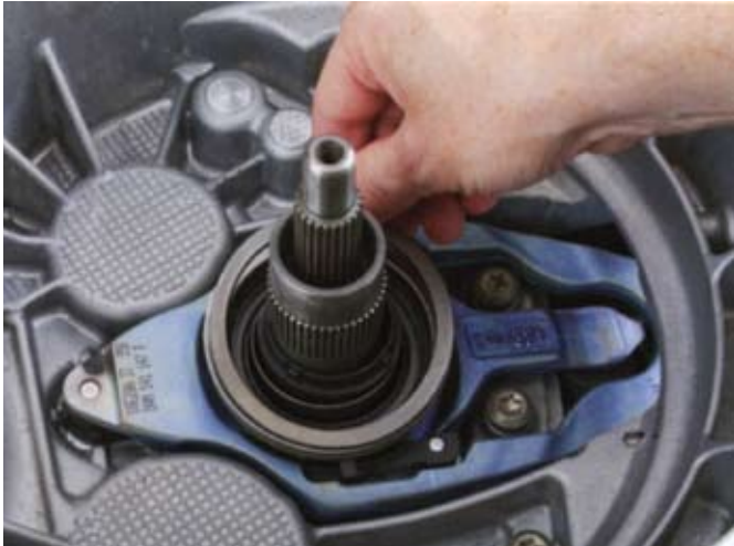
7. ábra: a nagy kinyomócsapágyra a legvastagabb hézagolóalátétet (2,8 mm) felrakni
