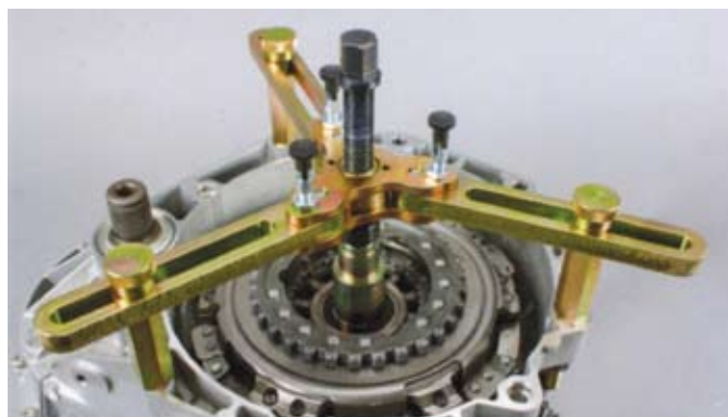
23. ábra: a keresztgerendát (KL-0500-60) a recézett csavarokkal (KL-0500-6020) feszülésmentesen a menetes csapszegekre szerelni
