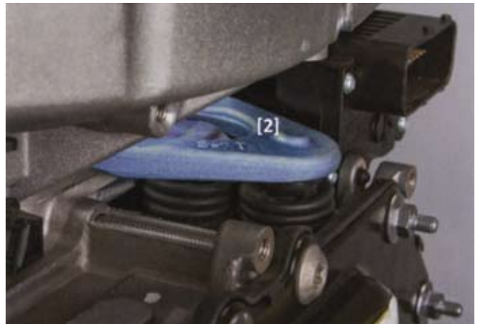
6. ábra: a kinyomóvilla helyes pozícióját biztosítani az állítóhengernél (2).
