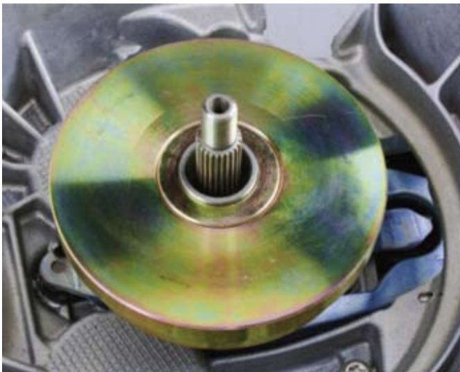
9. ábra: a 3,5 kg-os tömeget (KL-0500-6034) az idomszerre ráhelyezni; így érjük el az előírt előfeszítést
