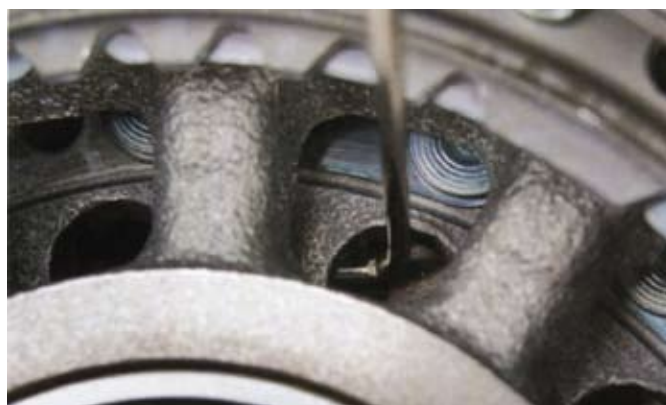
27. ábra: mindkét húzóhoroggal az alsó tengelykapcsoló tárcsát párhuzamosan felfelé meghúzzuk üközésig, és a légrést a mérőóráról leolvassuk.
