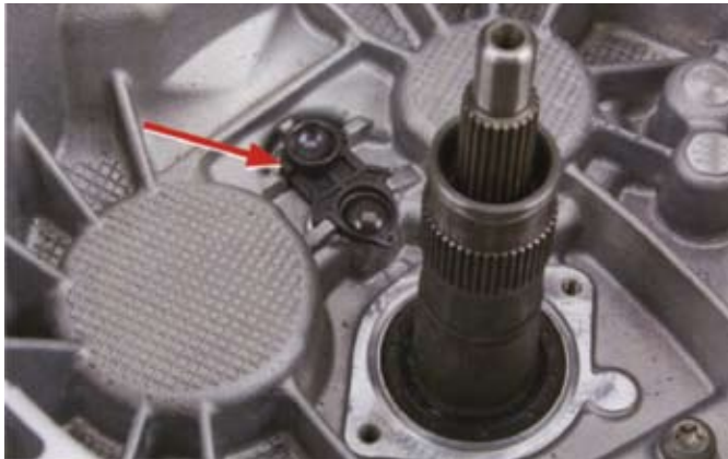
2. ábra: az új kinyomóvilla ellentartóját beszerelni; ez egyféleképpen tehető meg, a helyére csak be kell illeszteni
