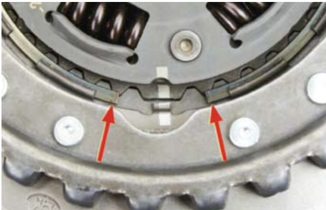
30. ábra: biztosítógyűrűt beszerelni. Megjegyzés: a biztosítógyűrű végei a szélesebb fogtól egyforma távolságra legyenek
