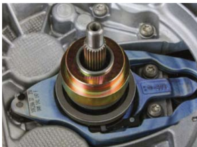
17. ábra: a 32,92 mm-es idomszert (KL-0500-6032) a kis kinyomócsapágyra ráhelyezni
