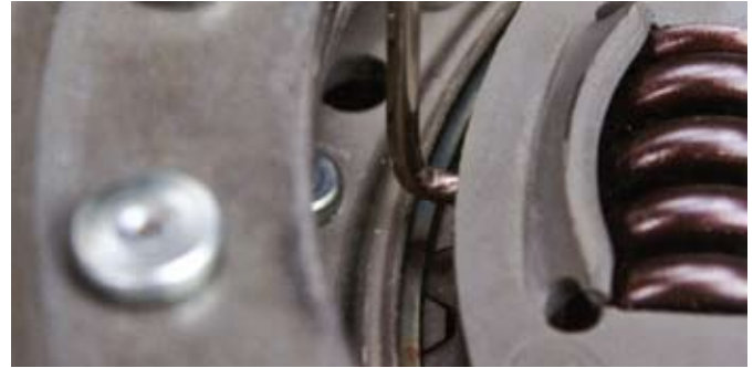
32. ábra: mindkét húzóhoroggal a felső tengelykapcsoló tárcsát párhuzamosan felfelé meghúzzuk ükőzésig
