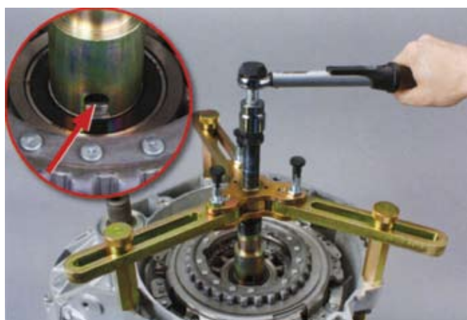
23. ábra: a keresztgerendát (KL-0500-60) a recézett csavarokkal (KL-0500-6020) feszülésmentesen a menetes csapszegekre szerelni
