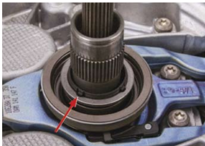
15. ábra: a kis kinyomóvillára a legvastagabb hézagolóalátétet (2,8 mm) felrakni; biztosítani, hogy a fülek a hézagolóalátét hornyaiba beleüljenek
