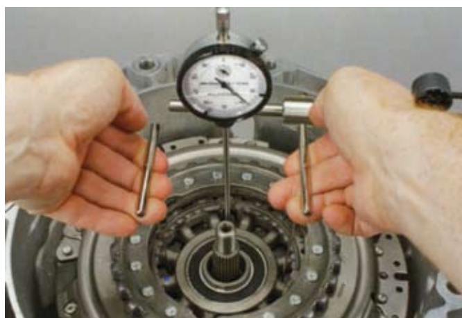
28. ábra: Megjegyzés: a légrésnek (a tengelykapcsoló valós hézaga) minden mérési irányból 0,3 mm és 1,0 mm között kell lennie. Ha a mért értékek kívül esnek ebből a tartományból, akkor a beállítás hibás, meg kell ismételni, lehetséges, hogy a hézagolalátét nem lett korrekten pozicionálva.
