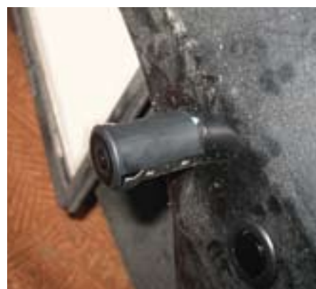
A kamera behelyezése a lökhárítón kiképzett furatba
