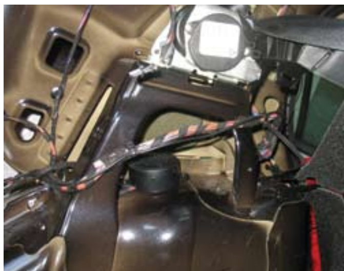
Az ECU és a hangszóró elhelyezése a csomagtéri oldalfalon, illetve a kerékjáratí dobon
