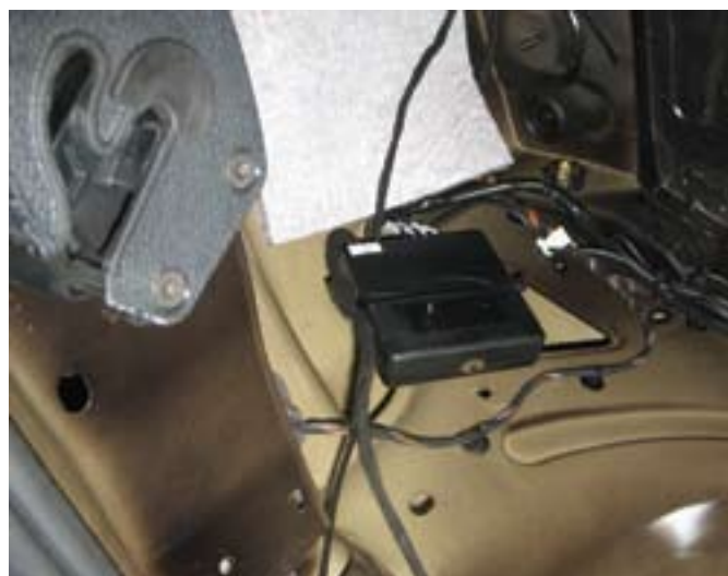
Az ECU és a hangszóró elhelyezése a csomagtéri oldalfalon, illetve a kerékjáratí dobon
