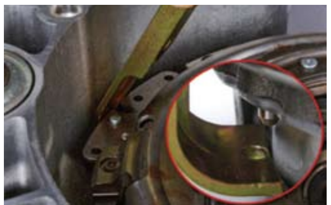
12. ábra: az első lehúzókörmőt a kettős tengelykapcsoló és a ház közé beilleszteni (befordítani), majd felfelé húzni; ekkor a kettős tengelykapcsoló alsó felén lévő központosító tűske beleül a lehúzókörmő közepén kialakított furatba
