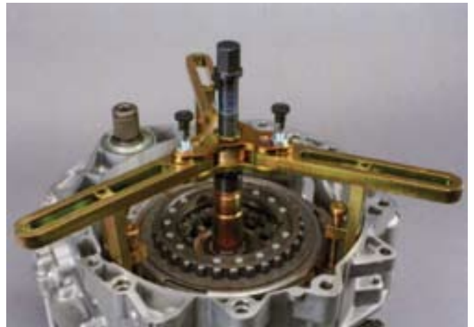
16. ábra: a lehúzót a támasztóhüvelyre és a lehúzókörmökre helyezni. Az orsót visszahajtani, hogy a recézett csavarokat feszülésmentesen lehessen felszerelni
