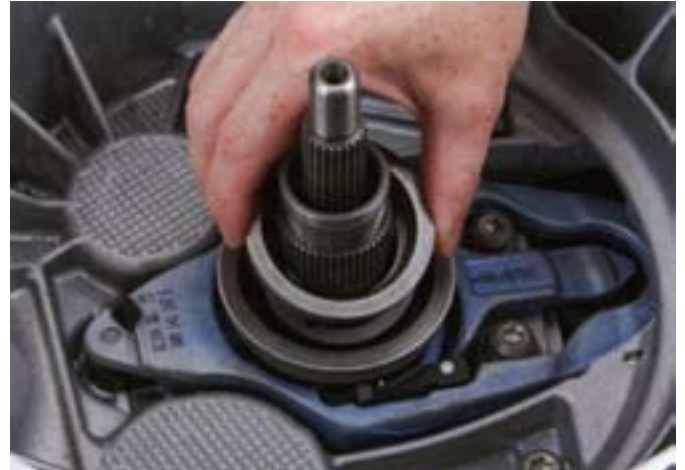
20. ábra: a kisebbik kinyomócsapágyat (K2 tengelykapcsolóé) a hézagoló alátéttel kiemelni. A modelltől függően a hézagoló alátét vagy a kinyomócsapágy alatt vagy felett helyezkedik el
