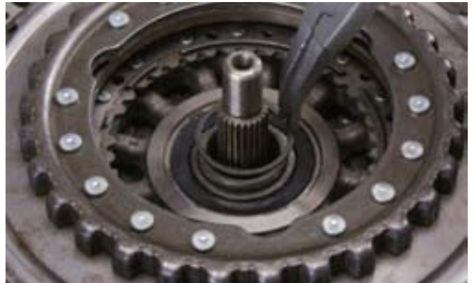
10. ábra: a Seeger-gyűrű-fogóval (KL-0192-12) a biztosítógyűrűt eltávolítani a csőtengelyről. Ilyenkor általában a biztosítógyűrű megsérül, azt ki kell cserélni.
