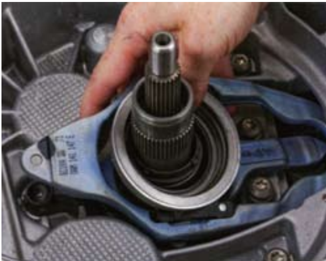
21. ábra: a nagyobbik kinyomócsapágyat (K1 tengelykapcsolóé) a hézagoló alátéttel, illetve a kinyomóvillával kiemelni
