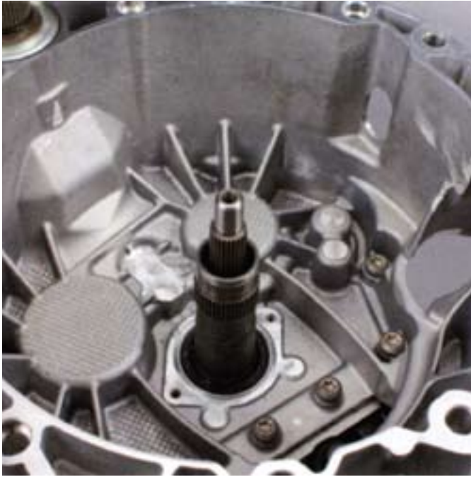
25. ábra: a sebességváltó behajtótengelyeit megtisztítani, a tengelyszimeringet ellenőrizni, hogy nem ereszt-e MEGJEGYZÉS: a bordázáson maradnia kell egy kis zsírnak
