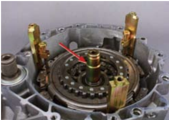
15. ábra: támasztóhüvelyt (KL-0500-6030) a csőtengelyre illeszteni MEGJEGYZÉS: a kettős tengelykapcsoló kiszerelésekor a lehúzó erre támaszkodik rá.
