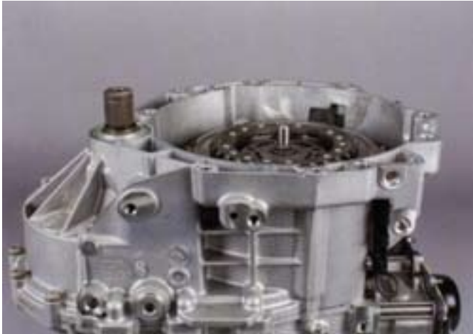
7. ábra: a sebességváltót egy állványra szereljük, vagy munkapadra tegyük úgy, hogy az ne billegjen, illetve a kuplung vízszintesen felfelé nézzen
