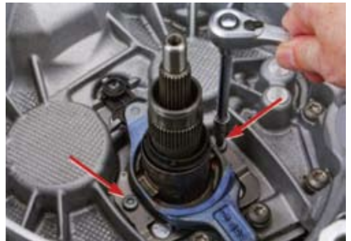
22. ábra: a tartó mindkét csavarját (Torx T30) kicsavarni
