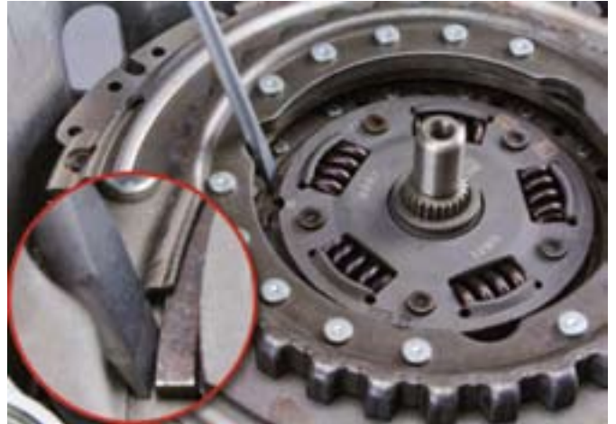
8. ábra: csavarhúzó segítségével a felső tengelykapcsolóagy biztosítógyűrűjét eltávolítani
