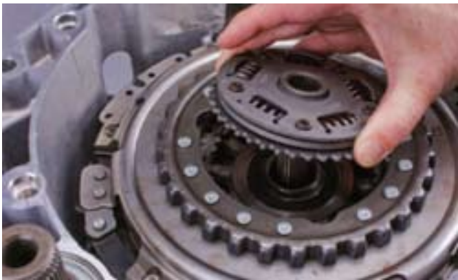
9. ábra: kiszerezni a biztosítógyűrűt és a tengelykapcsolóagyat
