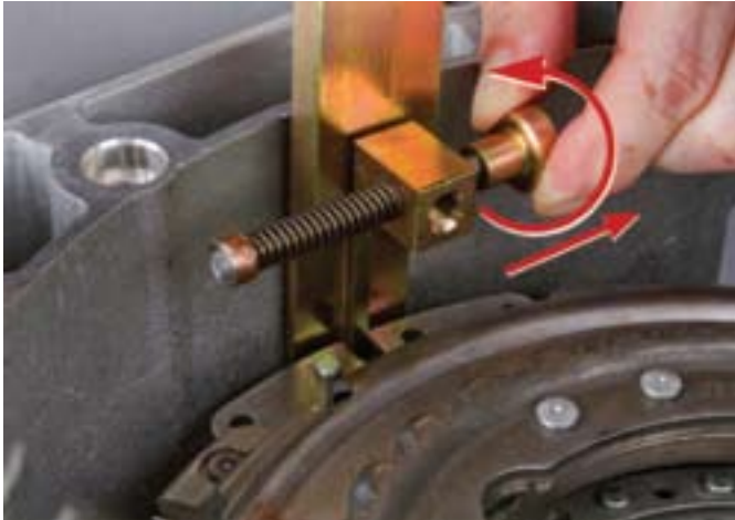
13. ábra: a rugós szorítót vízszintesen ráilleszteni a lehúzókörmökre. A nyomórészt rugó ellenében hátrahúzni, majd 90°-kal elfordítani és a kettős tengelykapcsolóra illeszteni
