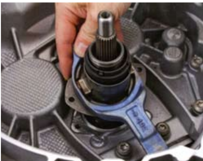
23. ábra: a tartót, a kinyomóvillát és a vezetőhüvelyt kiemelni. Korábbi váltóverzióknál a tartó hiányzik
