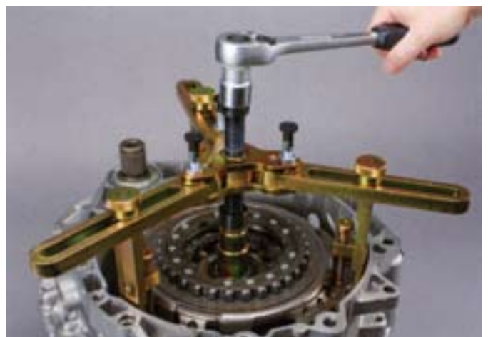
18. ábra: a kettős tengelykapcsolót a csőtengelyről az orsó forgatásával lehúzni
