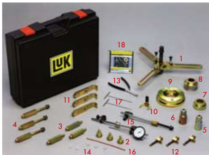
5. ábra: 1 – Keresztgerenda az orsóval és a nyomórészsel, 2–3 db recézett csavar, 3–3 db menetes csapszeg M10, 101 mm hosszú, 4 – 3 db menetes csapszeg M10, 161 mm hosszú, 5 – Támasztóhüvely kiszereléshez, 6 – Nyomóhüvely beszereléshez, 7 – Idomszer 32,92 mm, 8 – Idomszer 48,63 mm, 9 – Tömeg 3,5 kg, 10 – Ellenőrzővilla az idomszerekhez, 11 – 3 db lehúzókörcs, 12 – 3 db rugós szorító, 13 – Seeger-gyűrű-fogó, 14 – Zárókupakok, 15 – Mérőóra tartóval, 16 – Mágnes, 17 – Húzóhorog, 18 – DVD a szét-/összeszereléshez
