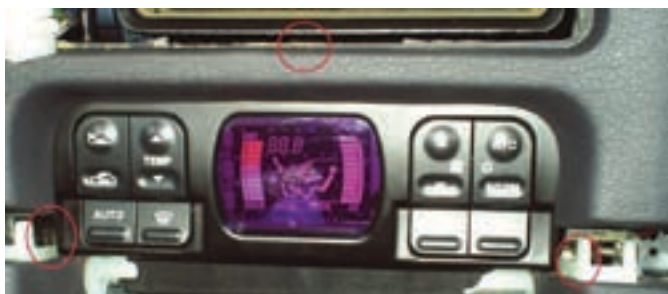
1. ábra: a klímakijelző három rögzítőcsavarja
