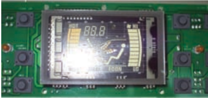
4. ábra: a kiforrasztandó furatszerelt LCD-kijelző
