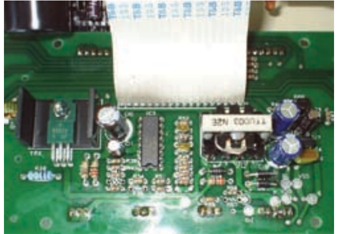
5. ábra: a kicserélt C14, C15 kondenzátorok és a D6, D7 diódák
