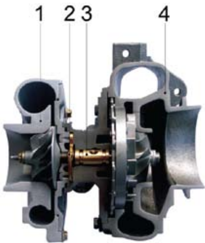
1. kép: a turbófeltöltő keresztmetszete. 1. Kompressziós/sűrítőház, 2. Axiális/támcsapágy, 3. Főcsapágy, 4. Turbinaház
