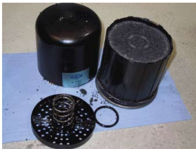
Olajleválasztó nélkül és olajleválasztóval működő légszárítóbetétek belseje azonos üzemóra után
