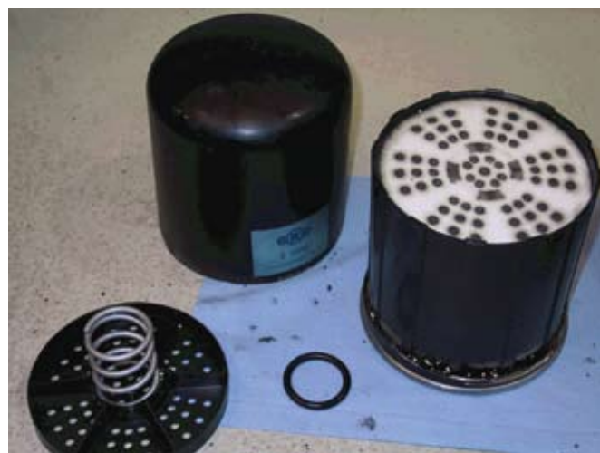
Olajleválasztó nélkül és olajleválasztóval működő légszárítóbetétek belseje azonos üzemóra után
