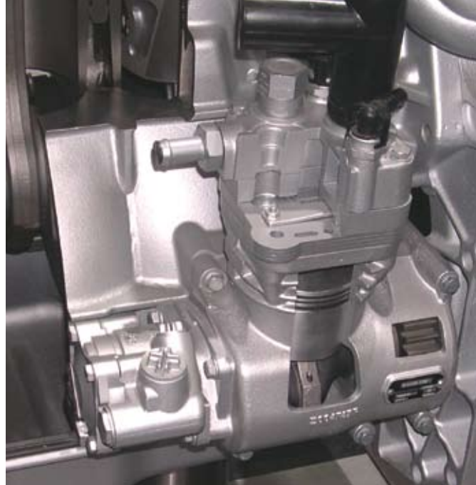
Motorra integrált egyhengeres kompresszor
