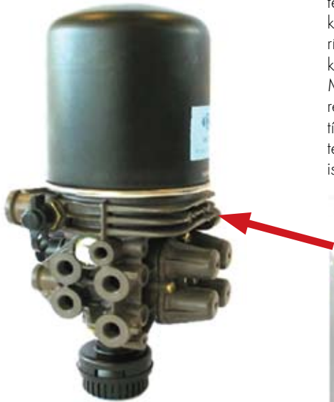
A légszárító és az olaj- és kondenzátumleválasztó kombinációja
