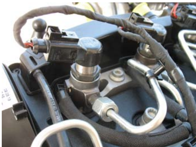
14. ábra: az injektor tüzelőanyag-csatlakozásai, piezoelemháza és elektromos csatlakozója. Két-két injektort egy lefogatóelem szorít az ülékre
