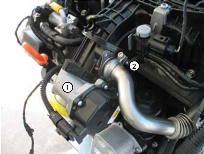
6. ábra: fojtószelepegység (1) és kipufogógáz-torkolat (2)
