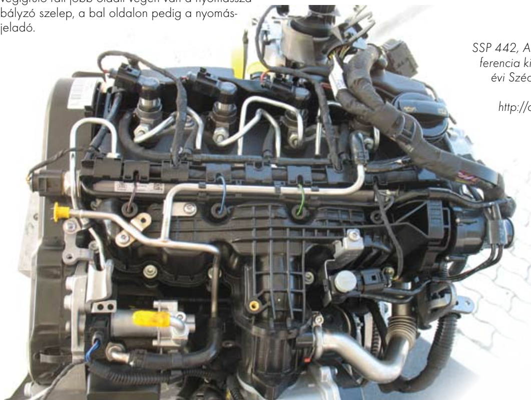
16. ábra: a motor felülnézete, melyen a tüzelőanyag-ellátó rendszer elemei jól felismerhetők
