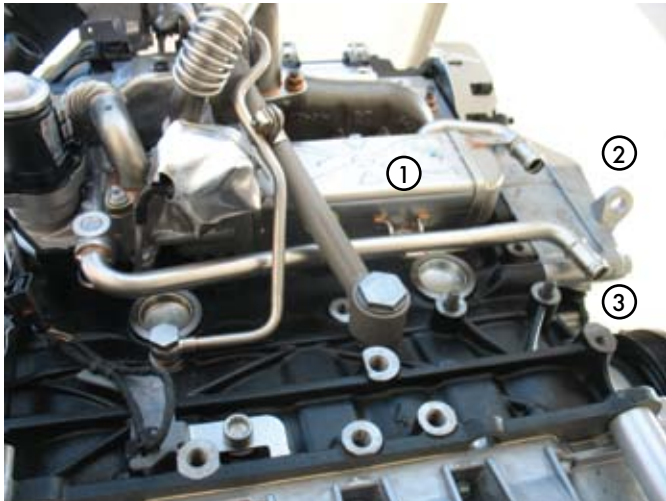
2. ábra: az AGR-egység a motor kipufogóoldalára csavarögzítéssel kerül fel - (1) - hűtőegység, (2) - hűtővízbelépés, (3) - hűtővízkilépés
